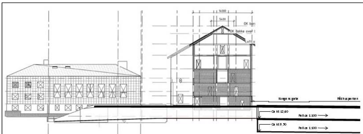
Figur 1: Snitt langs kulvert under Rådhuset
